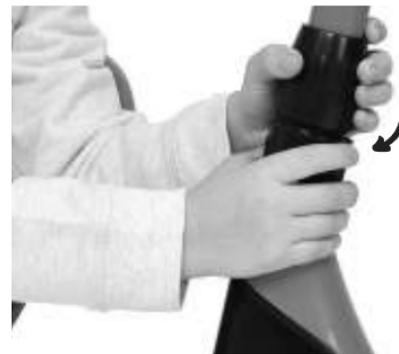
4. Затяни фиксатор рулевой колонки до упора, вращая его по часовой стрелке.
