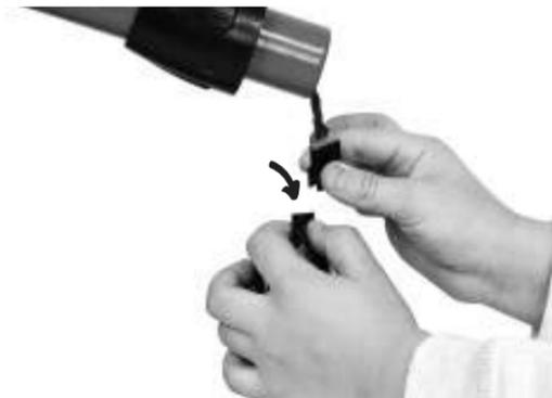
2. Соедини клемму кабеля управления в рулевой колонке с ответной клеммой в корпусе электросамоката.
