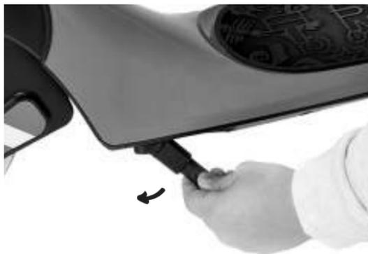
1. Выдвинь боковую подставку в рабочее положение и установи электросамокат на ровную поверхность.
